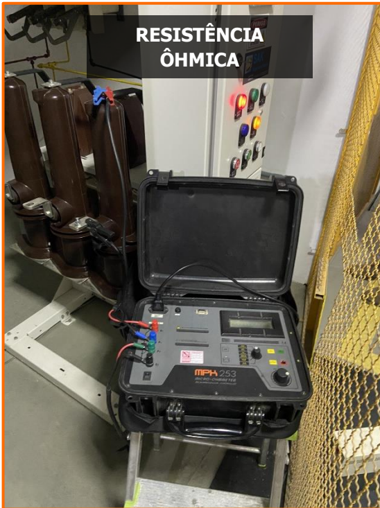
15 – Ensaio sendo realizados no disjuntor de média tensão.
