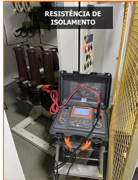
15 – Ensaio sendo realizados no disjuntor de média tensão.
