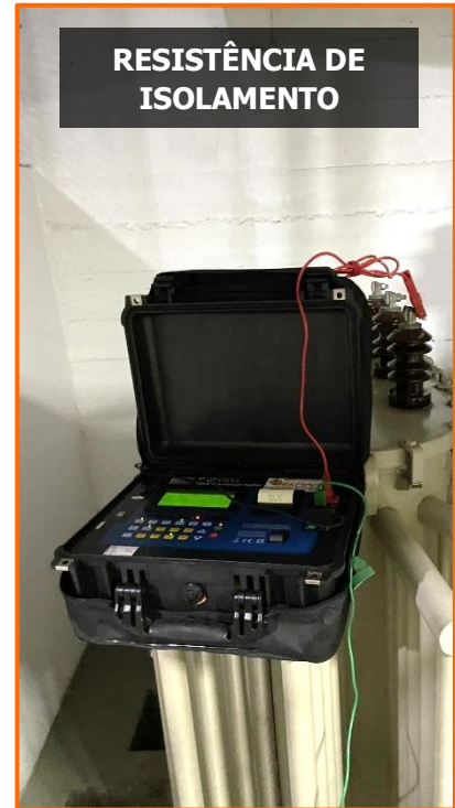
22 – Ensaio elétrico sendo realizado no transformador.
