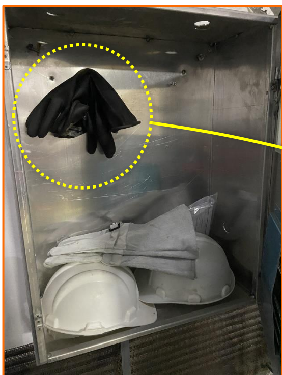
27 – A luva isolante da subestação apresenta selo do teste de isolamento vencido.
