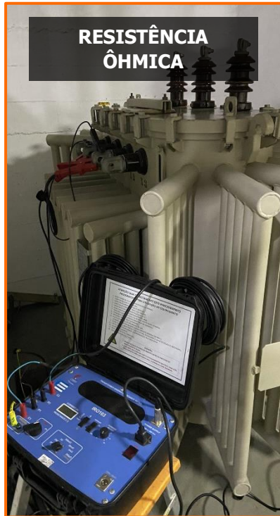
22 – Ensaio elétrico sendo realizado no transformador.
